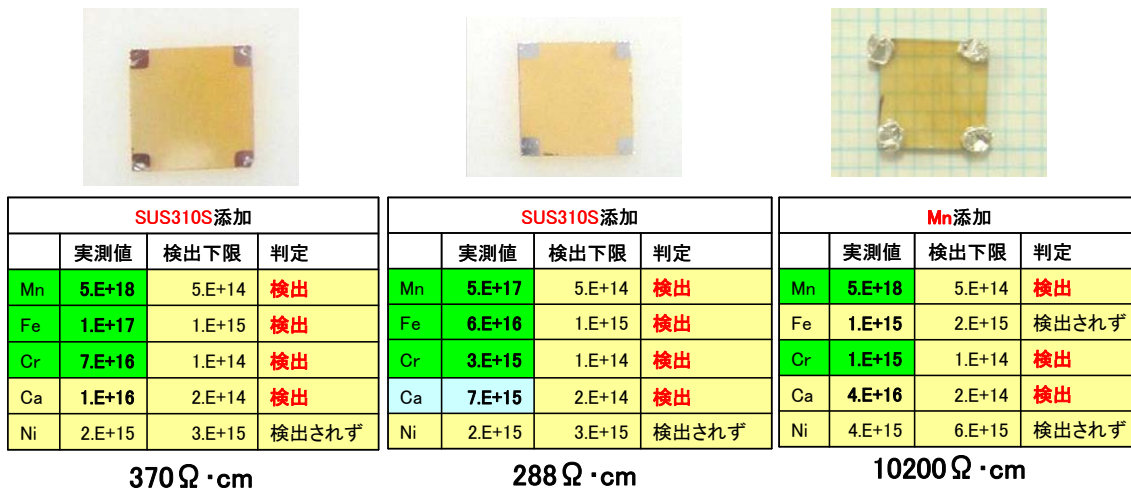
図 47 Mn 添加 GaN 結晶のサンプル外観、SIMS 分析結果と比抵抗
