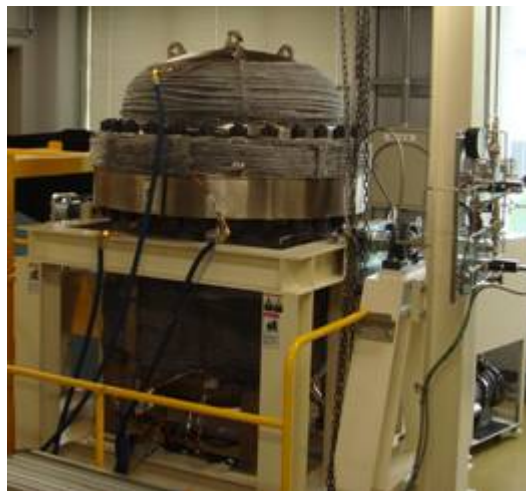
図4 大型 GaN 結晶育成装置
