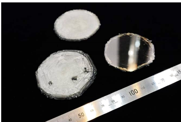
図 17 揺動式溶液攪拌法により育成した 2 インチ有極性 GaN 基板
