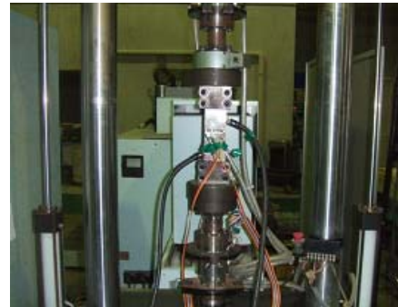
図①-3)-40 先進的な伝播モニタリング技術を実現した電場指紋照合装置
