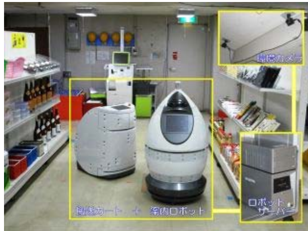
図5 ロボット搬送システム
