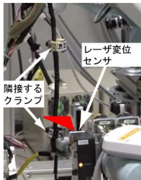
図 13. カメラ及びレーザによるワイヤー計測
