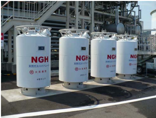
縦型容器 1~4号 (最大積載量: 200kg/基)
