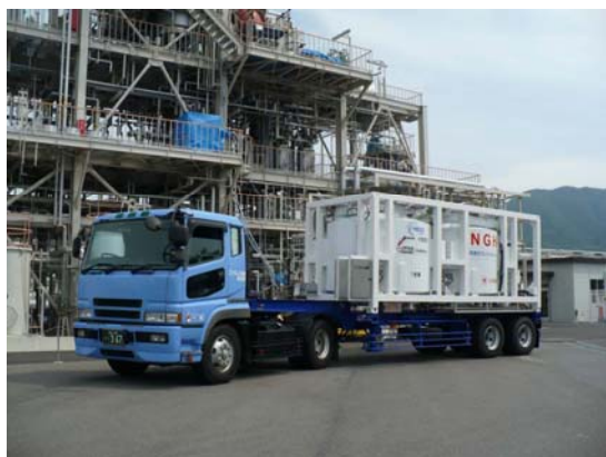
縦型容器 1, 2号車 (最大積載量:5トン/2基)
