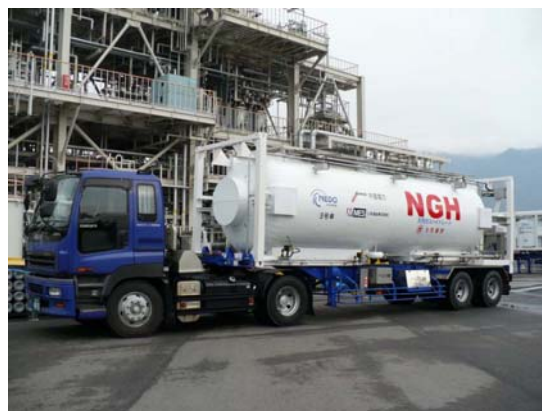
横型容器 3号車 (最大積載量:7.5トン)
