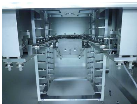
図j-1) -2 インライン装置の基板送出し機構内部
