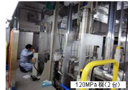
世界に類がない高圧水素ガス疲労試験機
