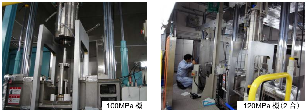
図 2.2.(2).1 導入し稼働させている超高圧水素ガス環境下材料試験機
