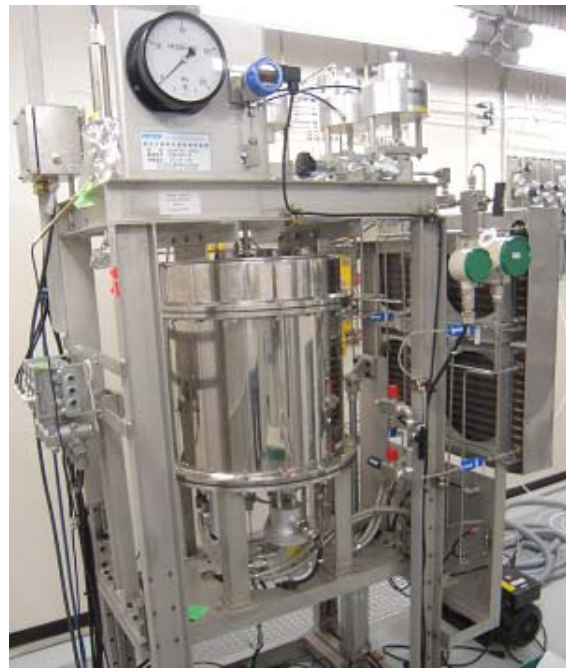
図 2.1.(3).6 高圧水素熱伝導率測定装置 (100MPa, 500°C)
