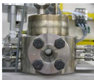
(B) 可視窓付き気液平衡セル
