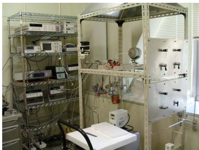
図 2.1.(1).12 水素音速測定装置
