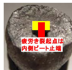
図 2.3.(2).9 疲労き裂起点
