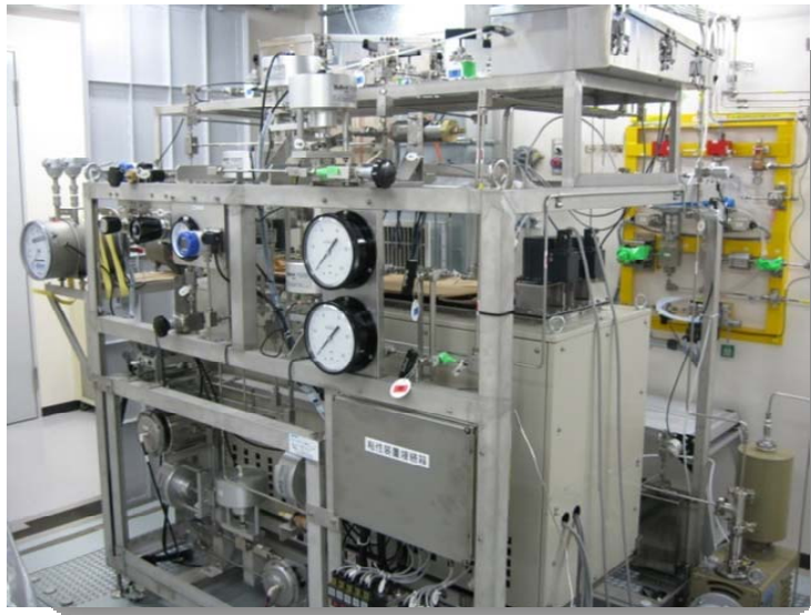
図 2.1.(2).2 細管式粘性係数測定装置(100MPa,250°C)
