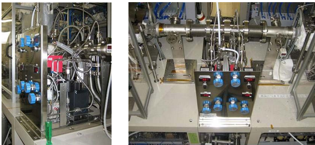
図 2.1.3-8 ガスバランスシステム
