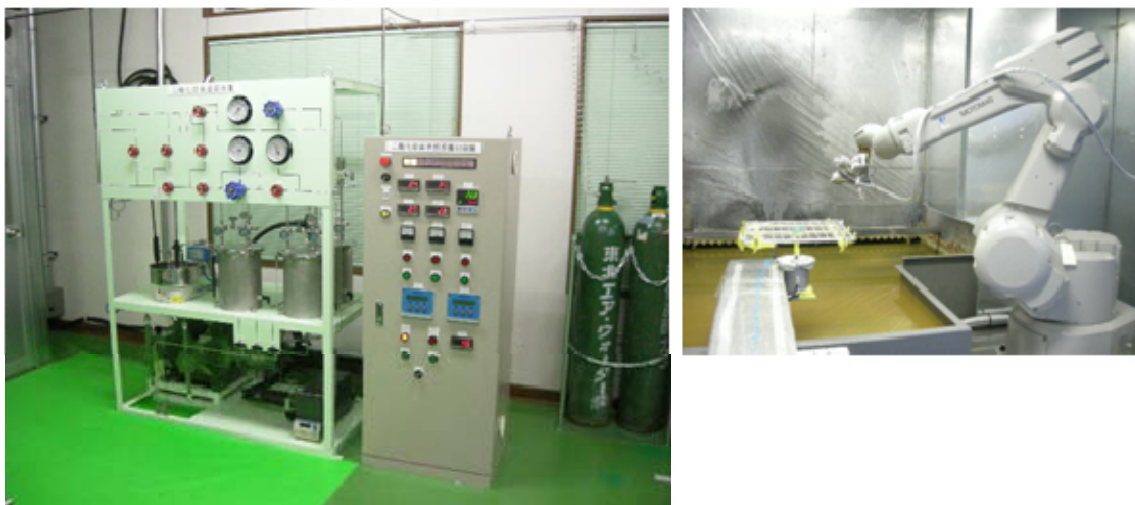
図 B-(5)-12 実用化塗装装置の概観写真 (左：装置本体、右：3次元塗装ロボット)
