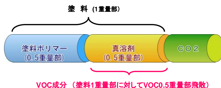
図 B-(5)-5 有機溶剤系スプレー塗装と二酸化炭素スプレー塗装の VOC 排出量の比較
