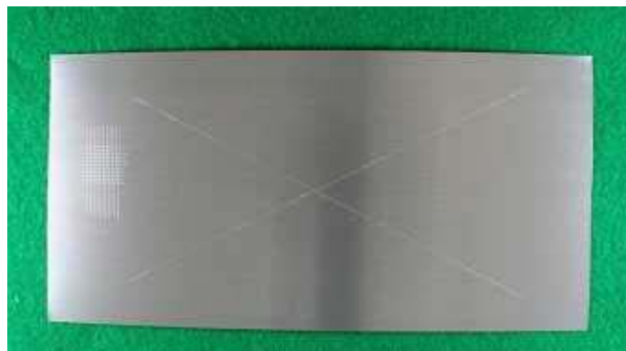
図 B-(3)-32 塩水噴霧試験結果
