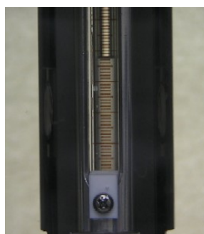
図 B-(5)-14 二酸化炭素の圧力 6MPa において懸濁した塗料
