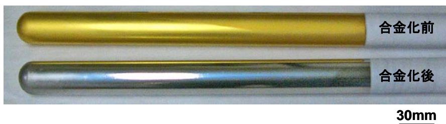
図 III.2.1.3-11 Pd-Ag-Au 膜(合金化前後)
