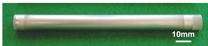
図Ⅲ.2.1.3-1 Pd 合金膜(直径 10mm)
