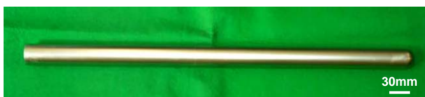
図Ⅲ.2.1.4-3 大型 Pd 合金膜(直径 30mm)
