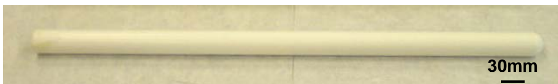
図Ⅲ.2.1.2-10 大型ジルコニア多孔質基材
