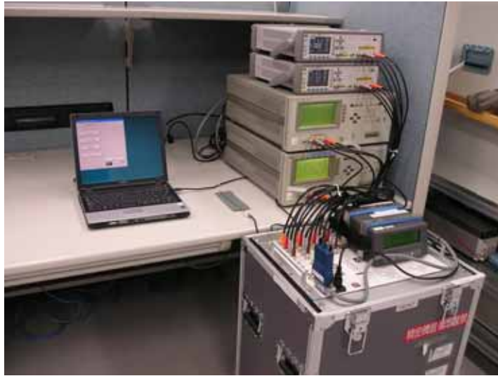
図 2.3-12 LCR メータ遠隔校正システム（可搬型）の外観
