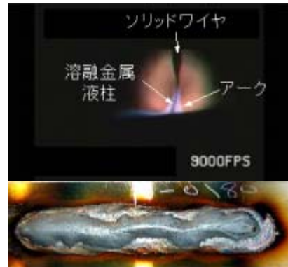
図①-1)-1 従来の純アルゴンMIGの不安定溶接例。溶接欠陥：蛇行ビード、アンダーカットが見られる。
