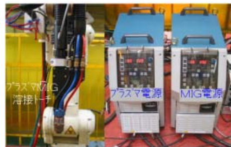
図①-1)-7 試作プラズマMIG溶接装置(協調電流制御電源)
