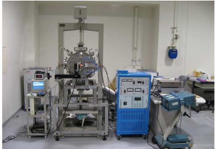
図①-4)-33 陽電子線クリープ損傷高温その場評価装置
