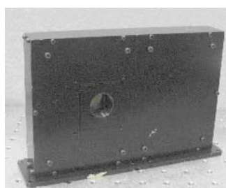
図 1.2.1-1 ハイパースペクトルセンサ VNIR 検出器部要素試作品
