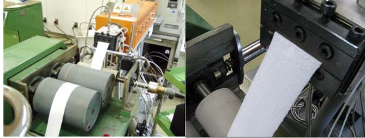
図 3.2.1.4.1.2 連続製造試験の状況
