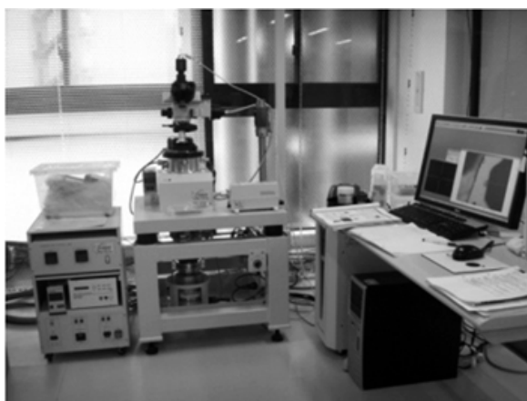
図①-51 原子間力顕微鏡(AFM)の装置外観図
