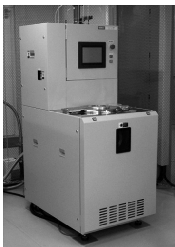
図①-62 ドライエッチング装置外観図 (サムコ株式会社:RIE-10NI)
