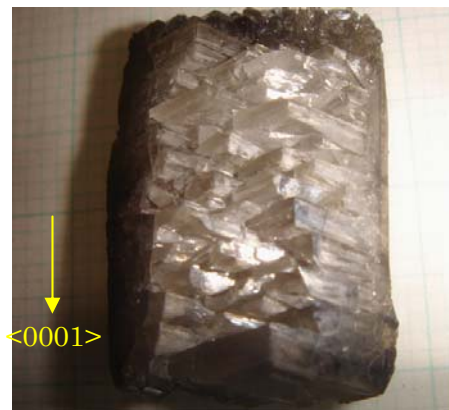
図 24 (11-22)GaN 基板の上に成長した GaN 結晶写真
