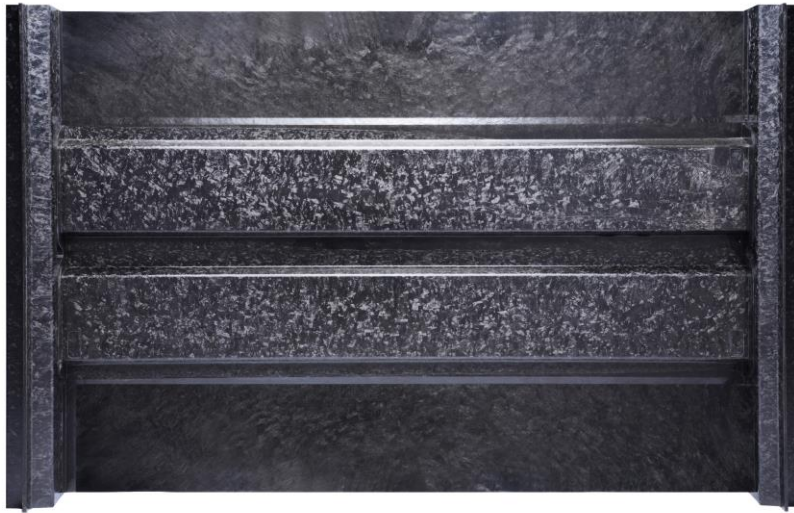
CFRTP製フロアパネル (名古屋大学NCC)
