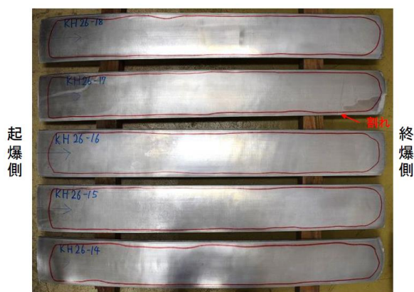
図 3-2.9.3-1 Mg(AZX611 合金)、Al(A6N01 合金)爆着接合体の外観(赤い部分の内側が接合された部分)
