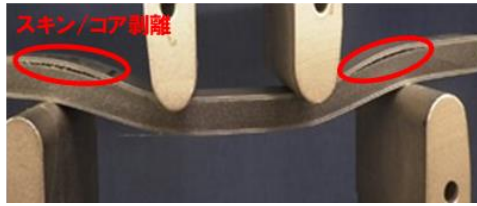
図 3-2.7.3.2-16 4点曲げ試験による接合面の剥離の様子（サンプルA）
