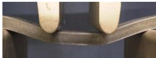
図 3-2.7.3.2-17 4点曲げ試験による接合面の「剥離なし」の様子（サンプルC）
