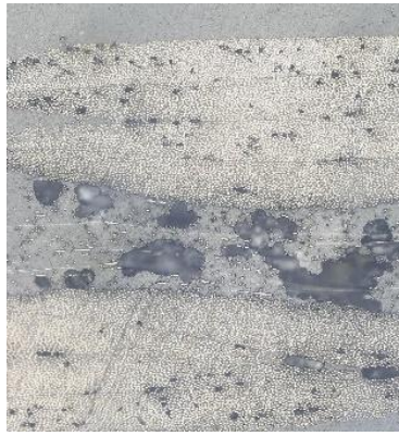
図 3-2.7.3.2-9 含浸が不完全な CFRP 平板断面の顕微鏡写真
