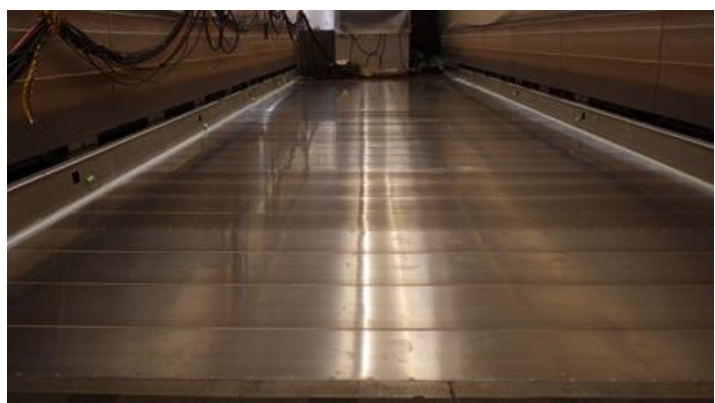
図 3-2.9.4①-8 実車両に適用された難燃性マグネシウム合金製客室床（幅 3m、長さ 9m）
