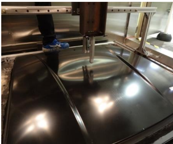
図 3-2.7.3.2-60 バックリングの様子 (左：スチール、右：CFRTP/CFRP*) (*CFRTP/CFRP ルーフはバックリングせず)
