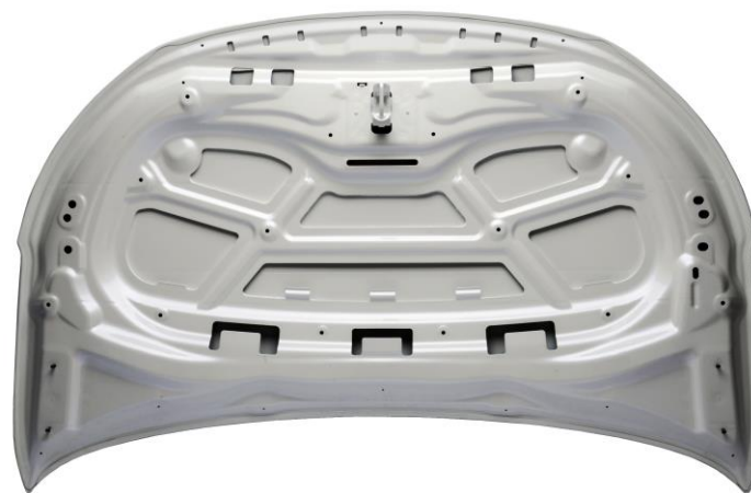
マグネシウム製フロントフード (トヨタ カスタマイジング&ディベロップメント)
