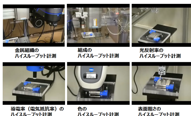
図 5 プローブ計測で物性を決定可能とするハイスループット計測手法の開発
