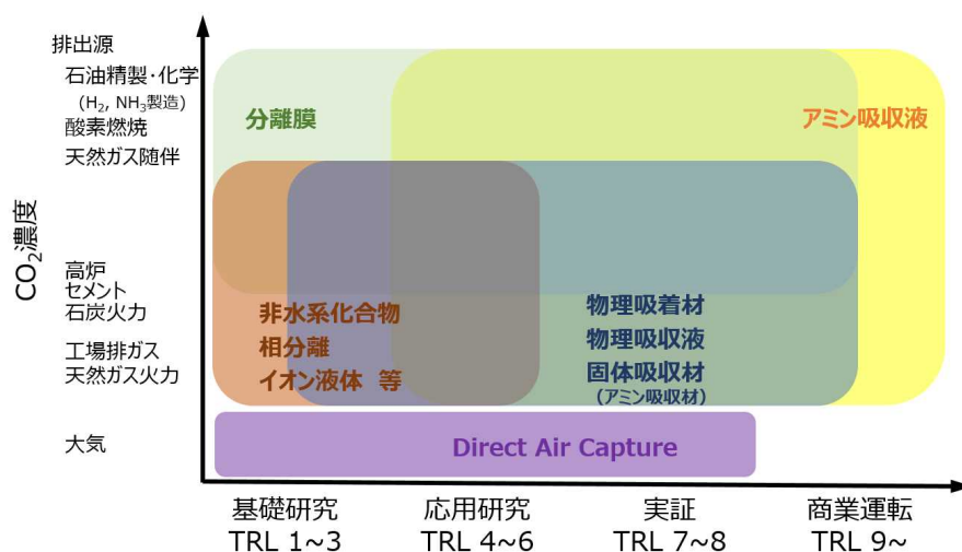
図8 各種CO 2 分離回収素材の現状の適応CO 2 濃度範囲と技術レベル(TRL)
