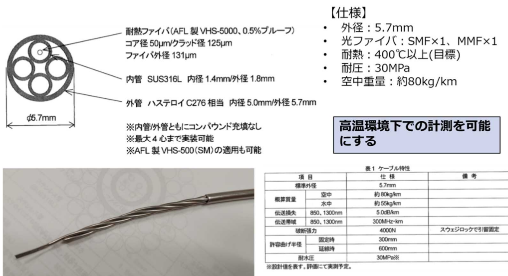
図 7-1-1 高温用光ファイバケーブル
