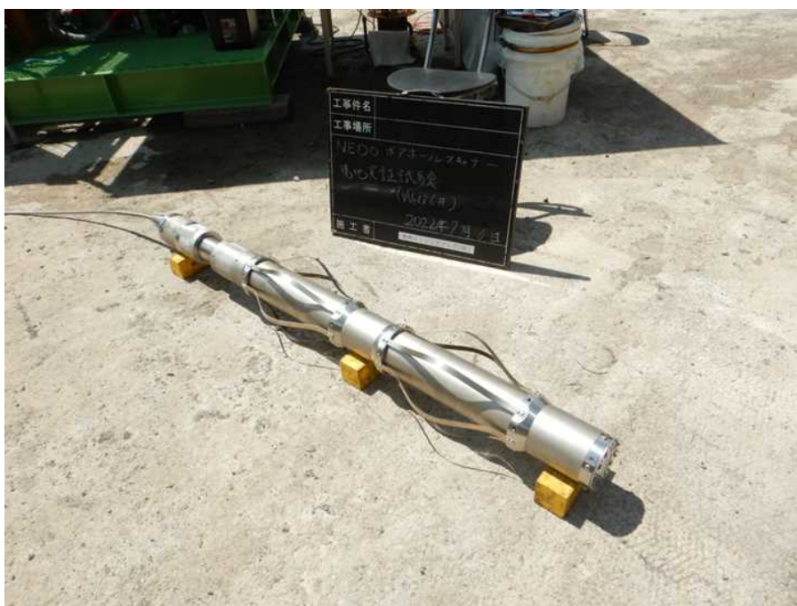
図 7.1-1 試作測定器 組立完成全体図
