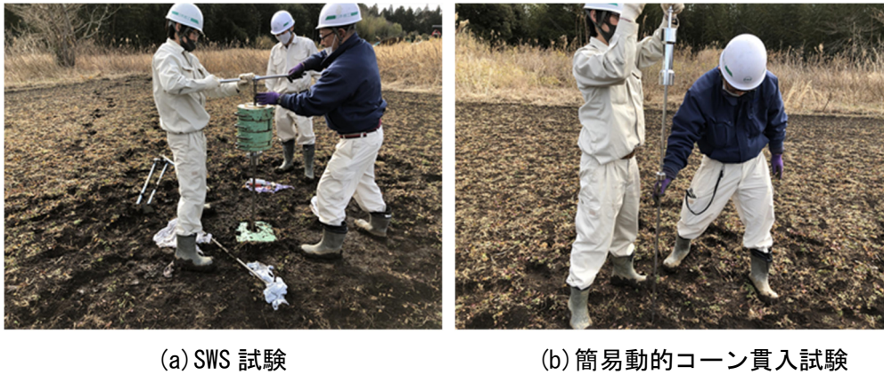
図 5-1 農地（畑）での原位置試験の例
