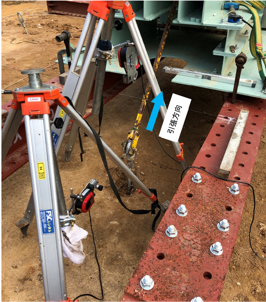
図 2-1 斜め引張試験状況（試験前）
