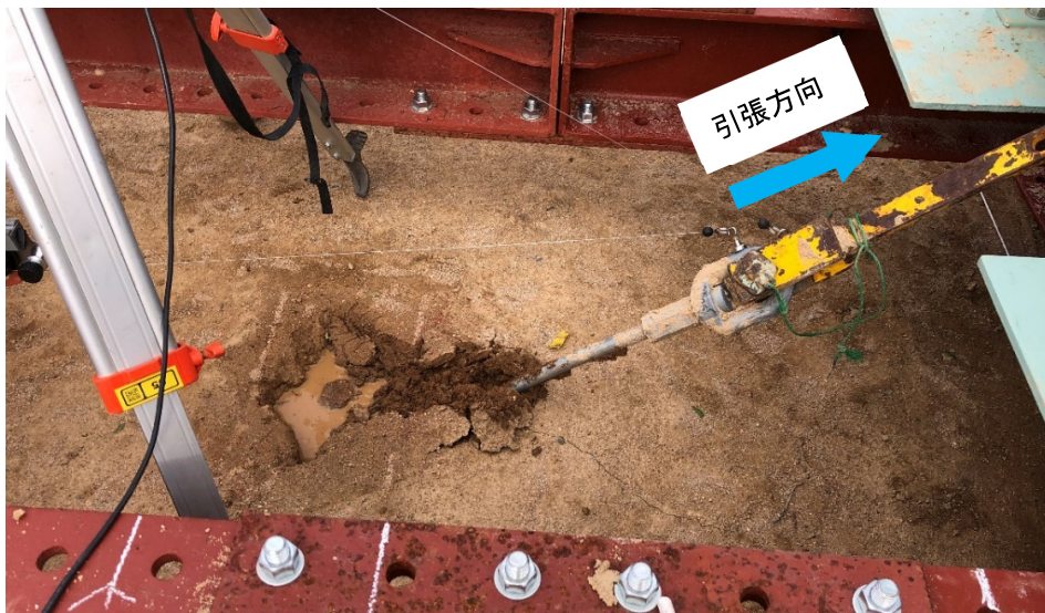
図 2-2 斜め引張試験状況（試験後）
