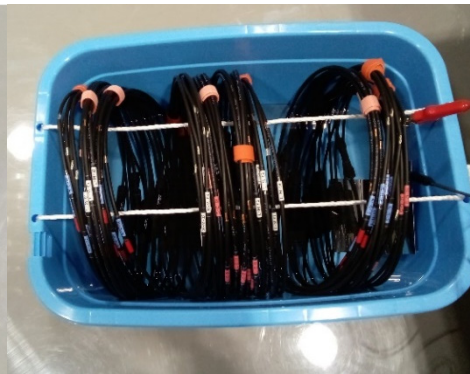
図 2-2 浸水試験状況
