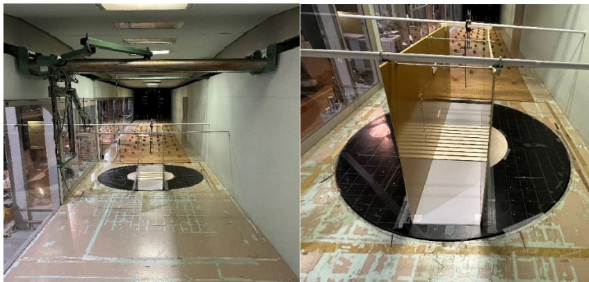
写真 2-1 風洞内模型設置状況
