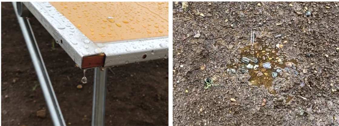
図 4-6 降雨時模擬 PV (左 : モジュール端部、右 : 雨だれ位置)
