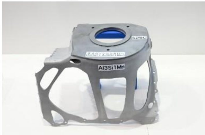
トポロジー最適化設計+3D造形：鉄AL製 サスタワー(日本積層造形)
