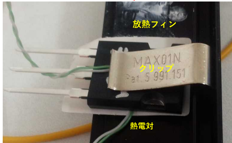
熱電対を裏面金属面に装着
