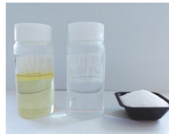
分解オイル（写真左）と回収スチレンモノマー（中央）と再生ポリスチレン（右）。
