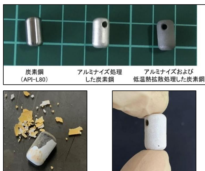
図Ⅲ(2.2)-2 炭素鋼（左下）及びアルミナイズド・低温熱拡散処理した炭素鋼（右下）にアルミナコーティングした試験片の超臨界水浸漬試験後の試験片
