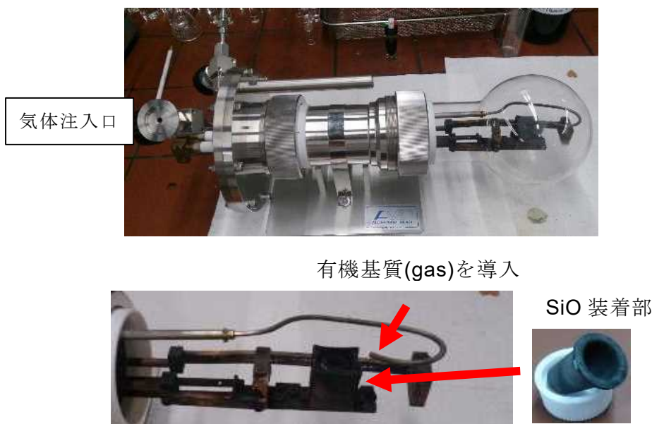
図①-4-5. 改良した気体状一酸化ケイ素発生・反応装置
