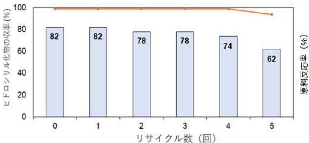
図②-1-1-7-14 DMF 保護酸化コバルト微粒子触媒による ヒドロシリル化の触媒リサイクル実験 (棒グラフ：ヒドロシリル化物の収率、折れ線グラフ：原料反応率)
