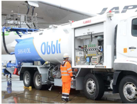
写真 1.3.7.2-2 給油車からの給油
