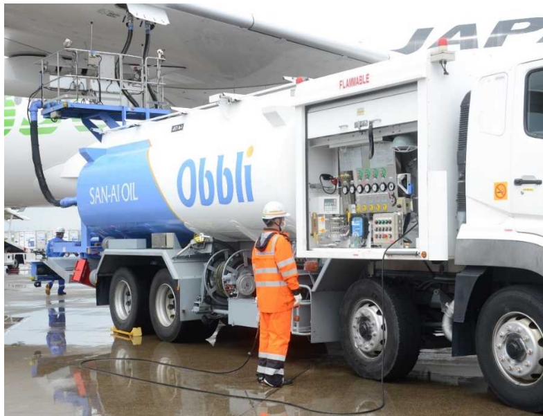
図 1-3-4 給油作業(日本航空株式会社提供)
