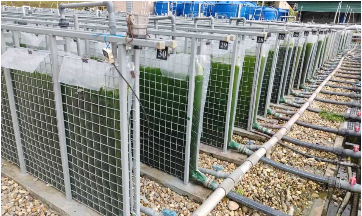
図3 Sarawak Biodiversity Centre において、24-m 長の PBR を多数用い、各種培養試験を実施している様子。2022 年 7 月より、大規模微細藻類培養システムの一部(48m 長 PBR を多数)用いて運用確認および各種培養試験が開始された。
