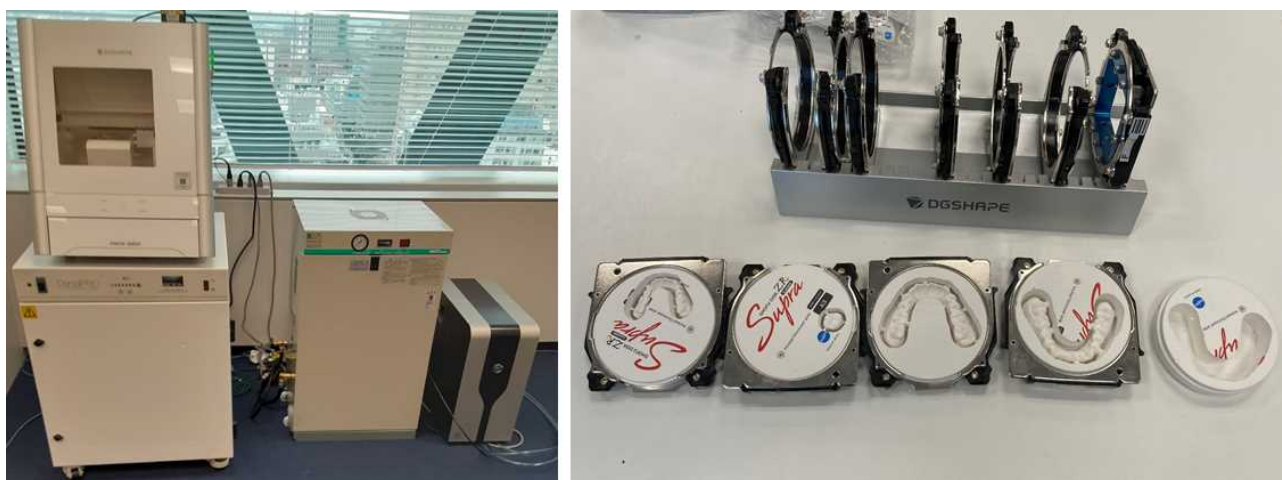
図 2-13-29. 購入した歯科医療向け 5 軸加工機およびテスト加工物
