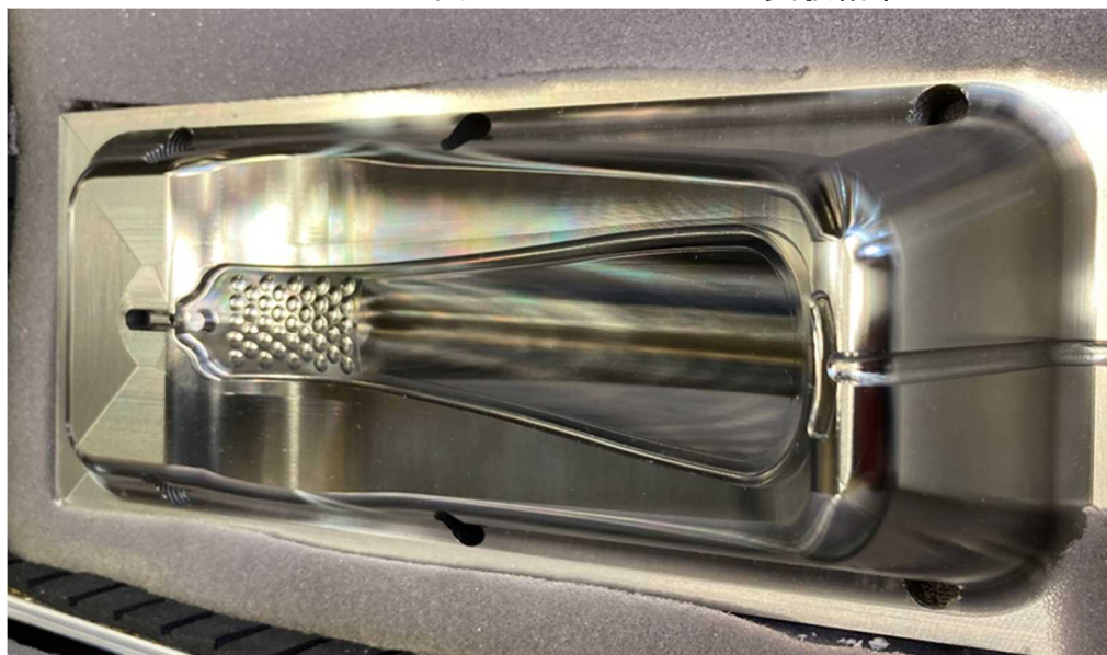
図 2-13-46. 金型加工実験結果 2 (意匠面あり)
