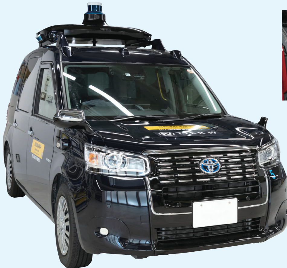
制御システム「Autoware」の他、LiDARや各種カメラを14機搭載し、GNSS(全球測位衛星システム)やIMU(慣性計測ユニット)を備える実験車両。
