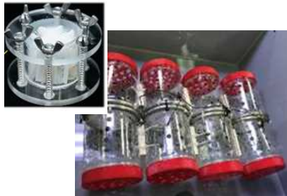
左上サンプルホルダー(9室) 海水、底泥が通る穴(2x8)
