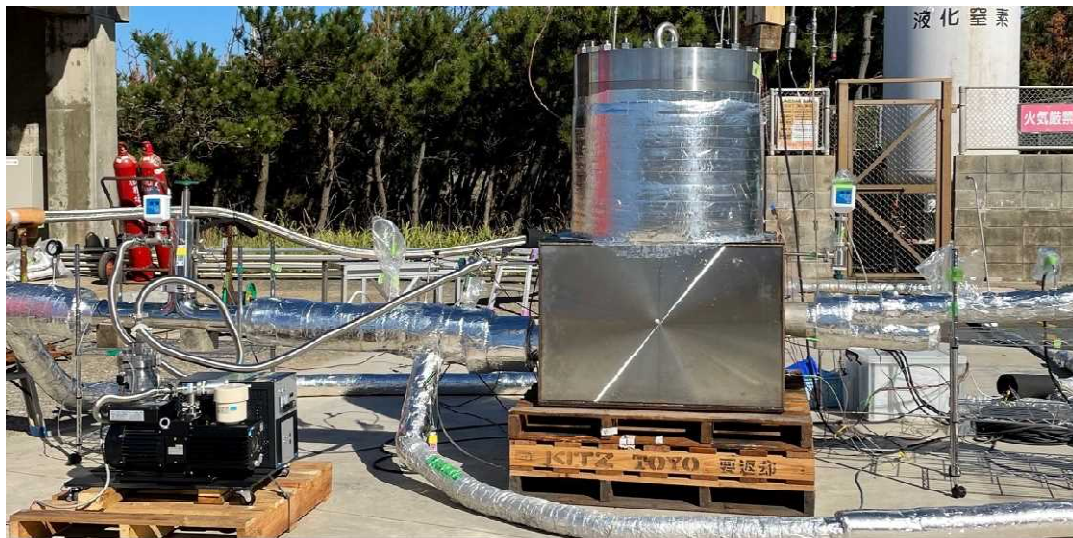
チャッキ弁 実流体試験状況
