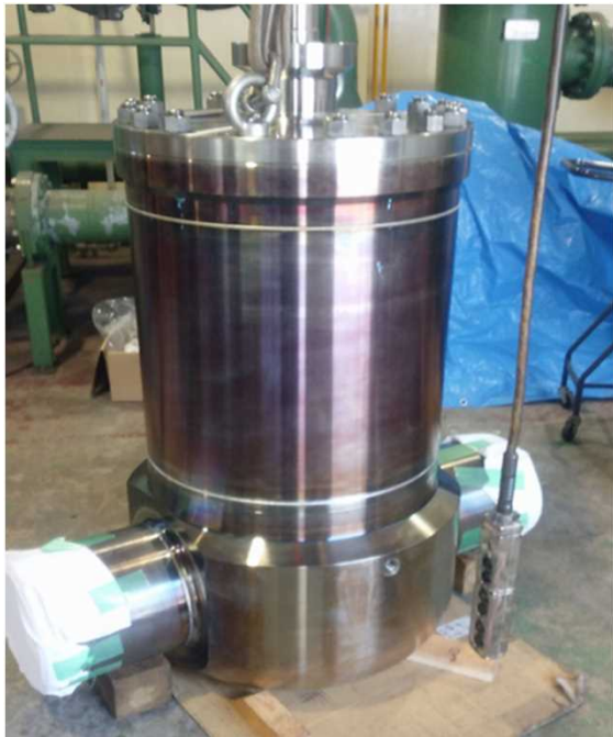
左図：ボール弁概観写真 ※ジャケット施工前
