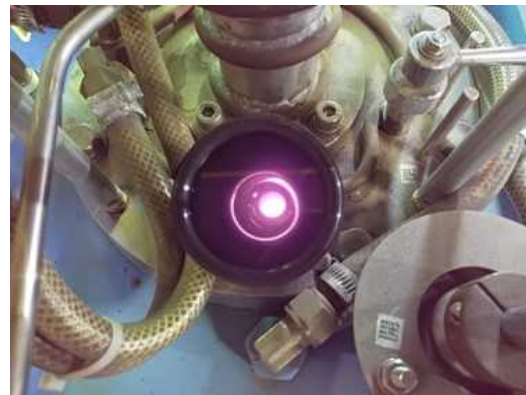
カルシアルツボを用いた溶解時の状況
