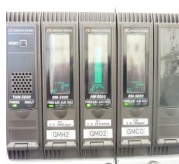
図 3.2.2.3-4 O_2 、 H_2 、 CO モニターによるチャンバー内環境常時監視、および強制停止機能
