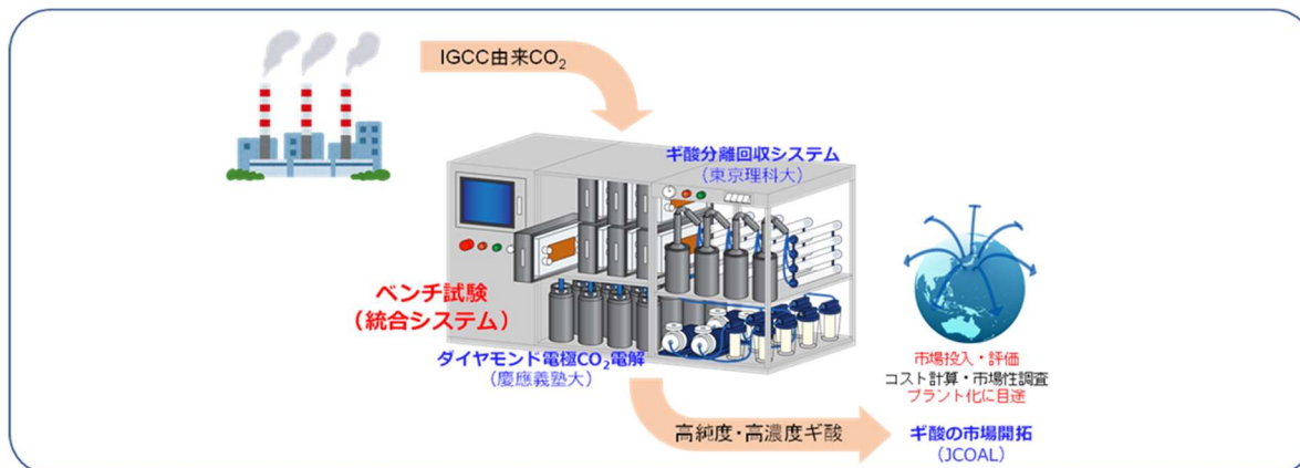
図 3.2.3.1-1 ダイヤモンド電極を用いた石炭火力排ガス中 CO 2 からの基幹物質製造
