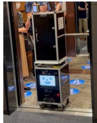
スマートロッカー搭載 エレベータと連携 Cuboidくん 屋内配送実証機
