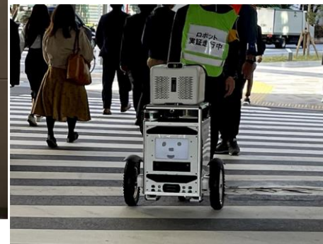
駆動系を屋外向けに 屋外走行実証機
