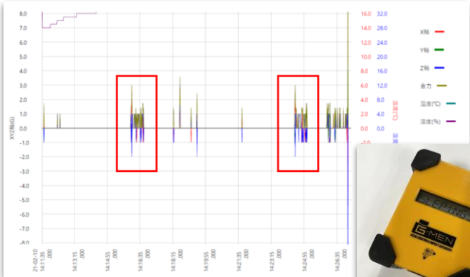
段差による衝撃測定画面
