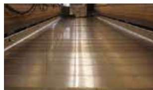
難燃性マグネシウム合金で作製した 新幹線車両の客室床
