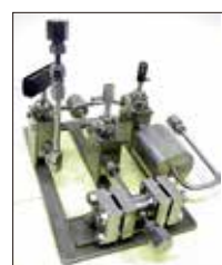
高精度熱物性測定機器(メニスカスの観察による冷媒の臨界点測定装置) 提供：九州大学
