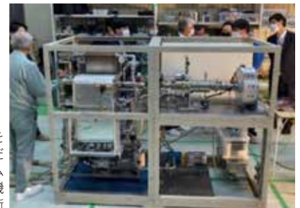
スクロール式膨張機(上)を 組み込んだ 「独立型ORC発電システム (5kW級)」の実証実験機 提供 : (株)馬淵工業所
