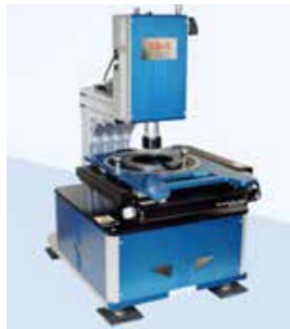
結晶転位高感度可視化装置(XS-1 Sirius)及び転位カウントヒートマップ 提供：名古屋大学、Mipox(株)
