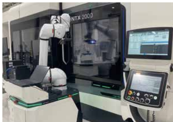
加工アシスト機能を搭載した多能工自走ロボット 提供：DMG森精機(株)
