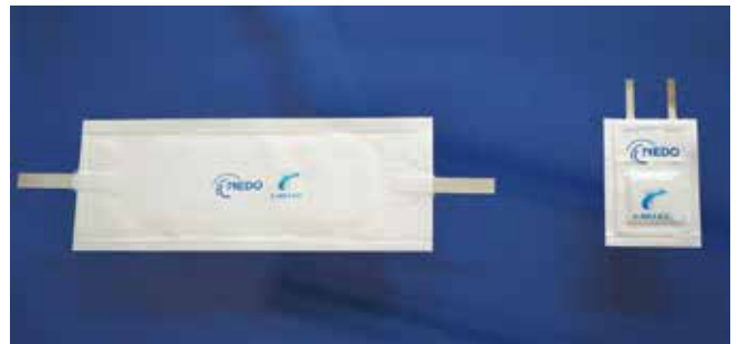
試作した硫化物系全固体リチウムイオン電池 提供：技術研究組合リチウムイオン電池材料評価研究センター
