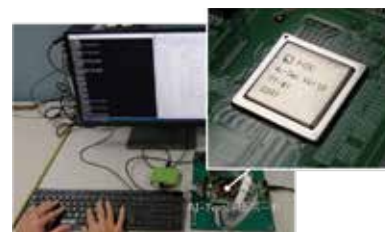
AIチップ向け独自IPの設計・評価プラットフォームの評価チップ、および評価基板 提供：産業技術総合研究所および東京大学
