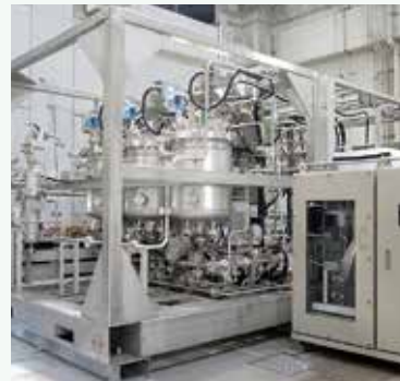
iFactory®のモジュール(左)と自動分析装置(右)
