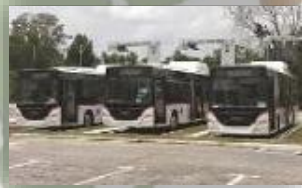
10分間充電運行による大型EVバス実証（マレーシア）
