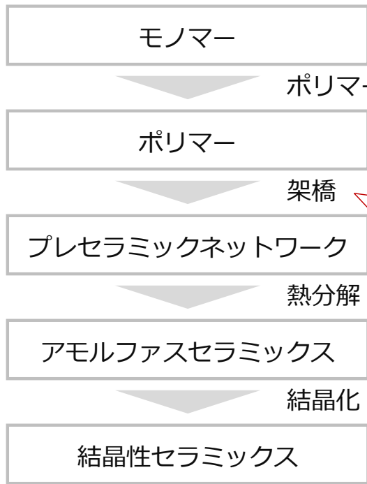
ポリマー由来セラミックスの製造フロー
