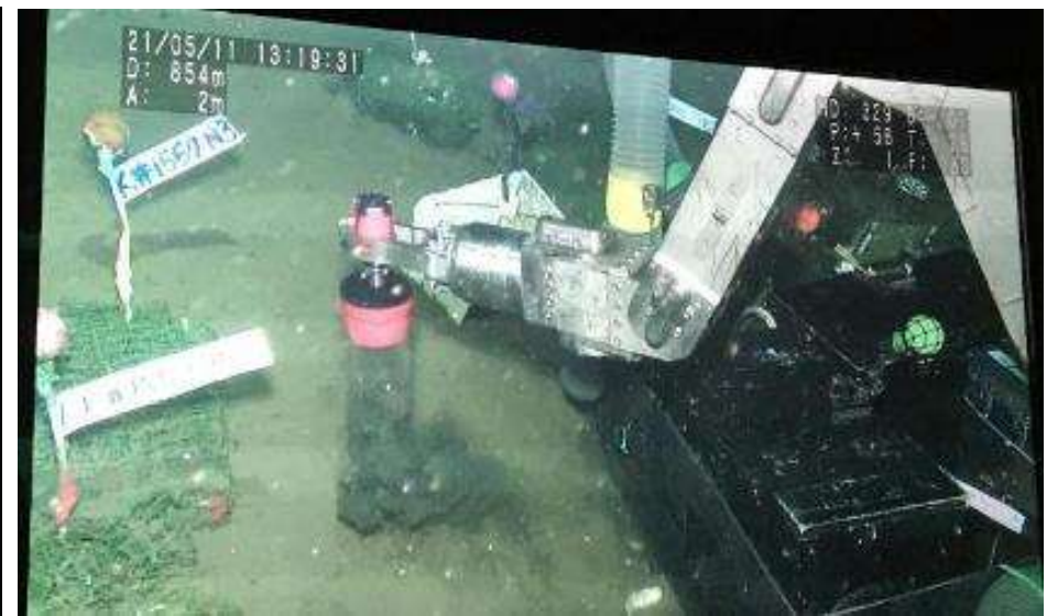
サンプル直下の海底土の採取
