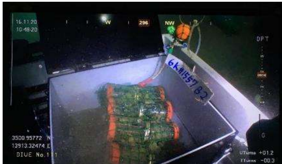
サンプル・海底土・深海水の回収
