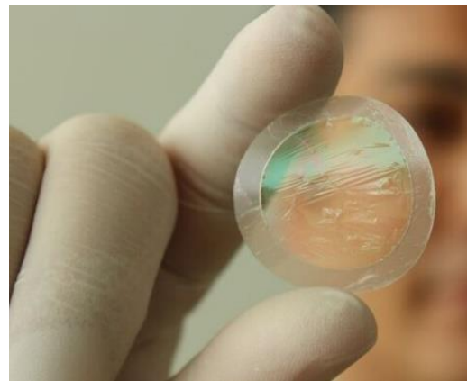
独自に開発した 圧倒的に高いCO 2 透過量を持つCO 2 分離ナノ膜
