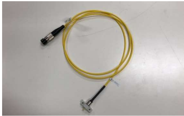
図Ⅲ2-3-7-7 TO-CAN パッケージした FP-LD 素子のファイバーピグテールモジュールの写真
