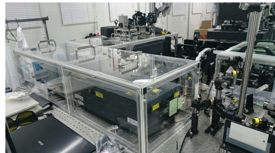
図Ⅲ2-4-1-1-12 波長制御型レーザー加工テスト装置の外観図 (左)パルス幅50fs (右)パルス幅190fs
