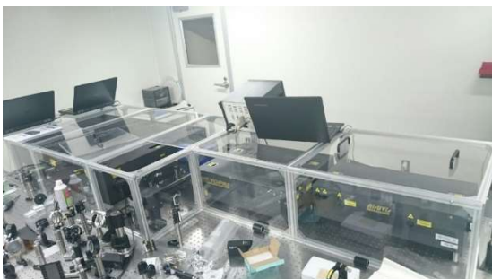
図Ⅲ2-4-1-1-12 波長制御型レーザー加工テスト装置の外観図 (左)パルス幅50fs (右)パルス幅190fs
