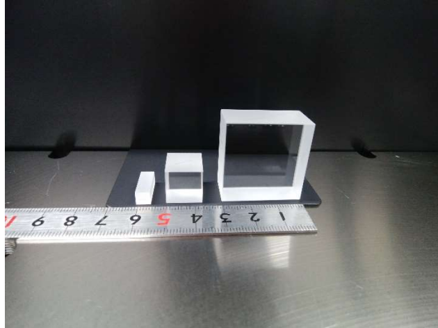
図Ⅲ2-1-1-6. 紫外光発生用大型波長変換素子 左から 5mm 角(市販サイズ)、13mm 角、30mm 角断面
