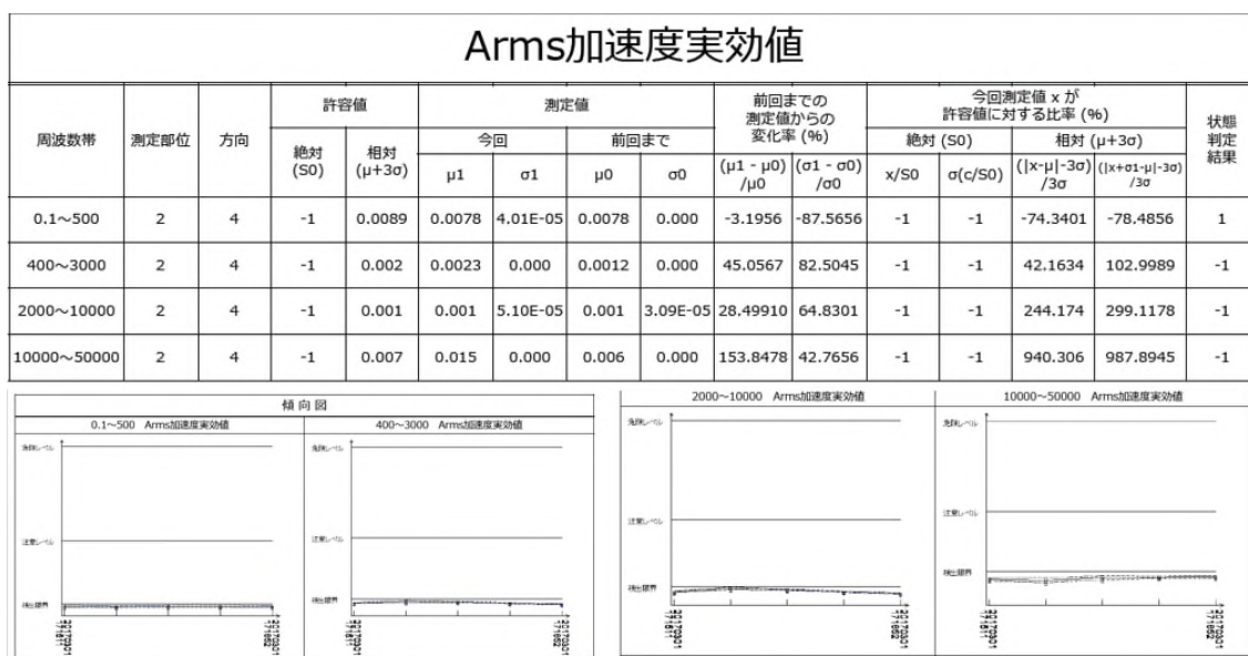
図 2.1.6-19 状態の傾向管理
