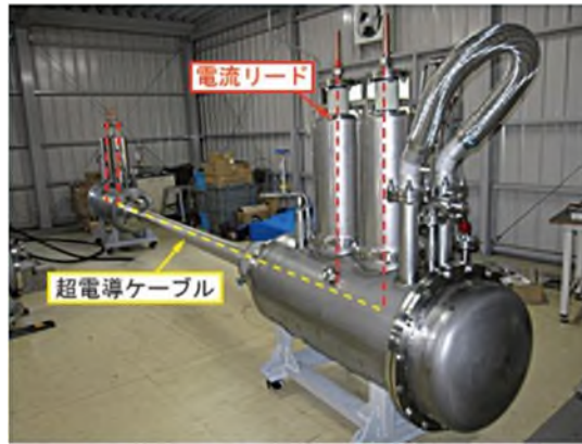
図 2.1.4-1 超電導き電線用電流端末
