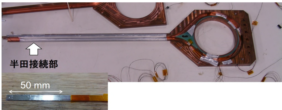
図 2.3.5-11 試料治具に取り付けた状態の試料とはんだ接続部
