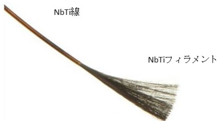
図 2.3.6-34 フィラメントを露出した NbTi 線材
