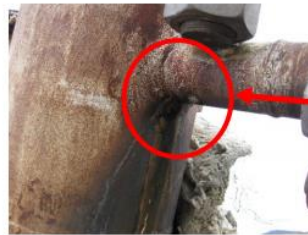
<IDDP-1 スプール損傷部拡大>
