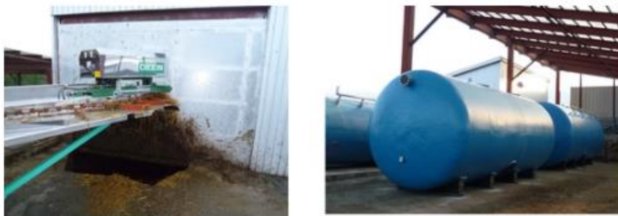
図 2.4.3 原料自動投入装置・原料前処理装置と、FRP 製メタン発酵槽（高温乾式） （出所）NEDO ニュースリリース
