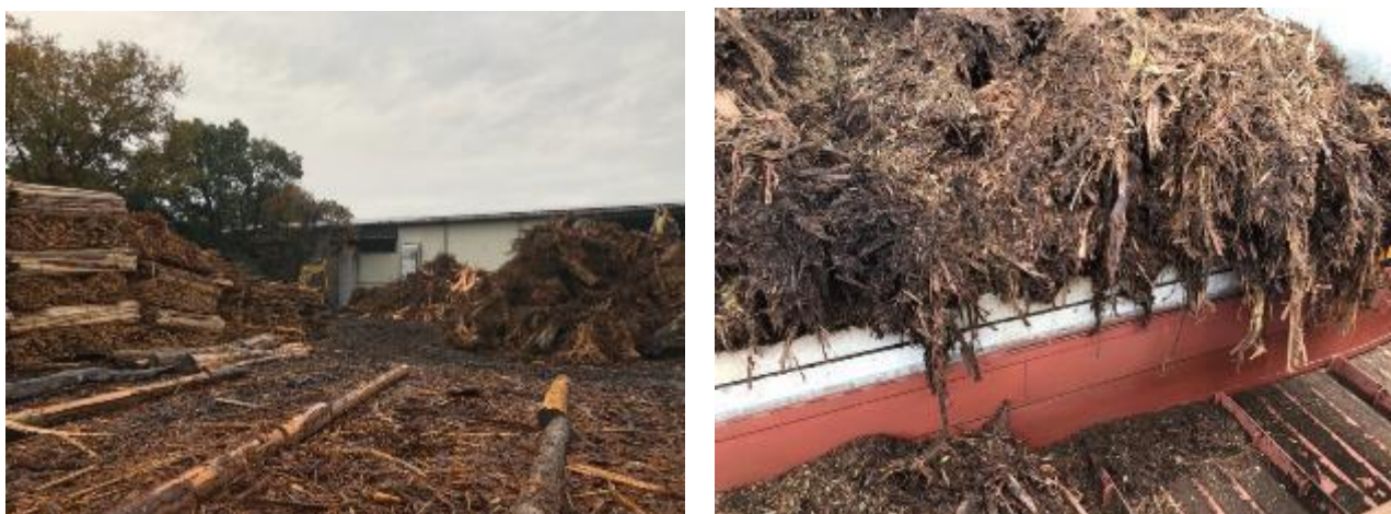
図 3.2.13 バンブーエナジー株式会社にて森林組合に野積みされた土場バーク(左)と ORC の投入コンベアの燃料バーク(右)
