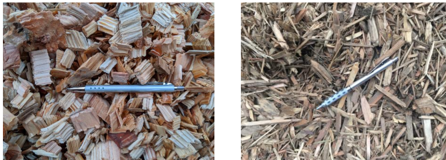
図 3.1.2 切削チップ（左）とピンチップ（右）
