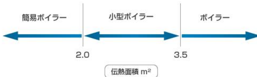
図 3.2.56 開放管またはゲージ圧力 0.05MPa 以下の U 形立管を蒸気部に取り付けたものによる区分 (いずれも内径 25mm 以上)
