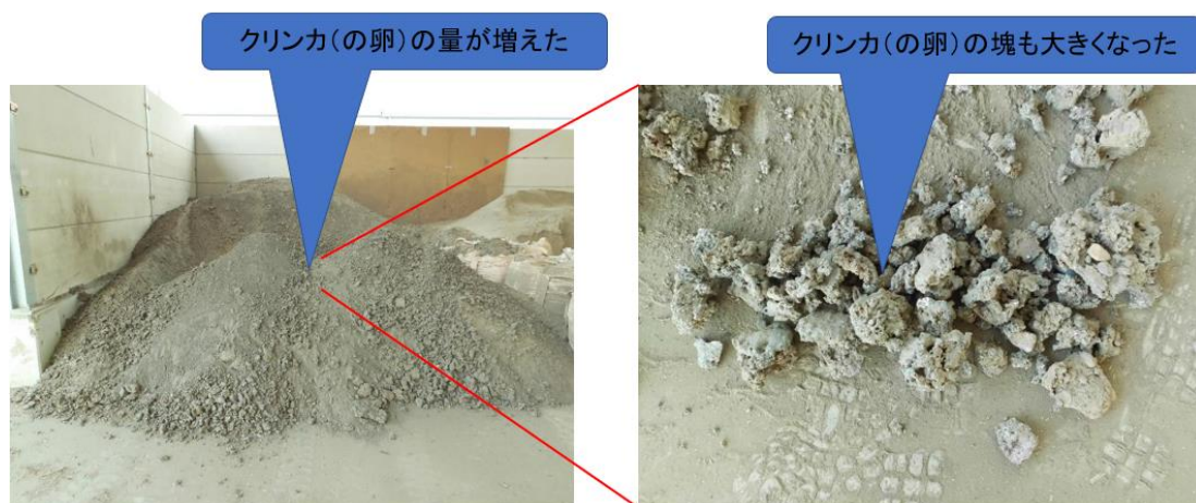
図 2.4.9 バンブーエナジー株式会社実証事業におけるバーク 2 割竹 8 割燃焼時の炉床灰
