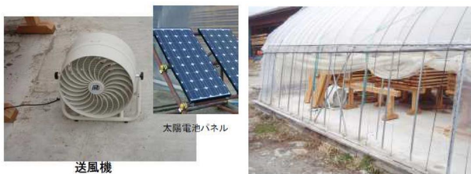
図 2.2.22 送風機と太陽電池パネル（左）、乾燥時の様子（右）
