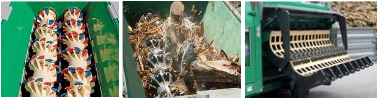
図 2.2.31 破砕設備（CRAMBO）の概観（破砕ローターおよびスクリーン）
