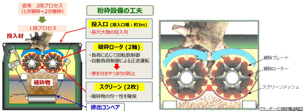
図 2.2.30 破碎設備（CRAMBO）の特徴とスペック
