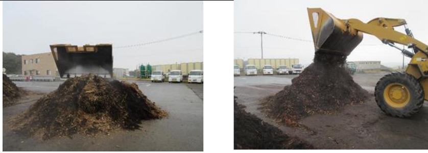
図 2.4.47 原料均一化作業の状況
