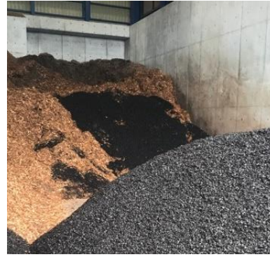
図 2.2.20 バークチップ（写真左：左上、中下）と枝葉チップ／PKS（写真左：手前） を受け入れた燃料槽内の様子（奥がバークチップ）（写真右）
