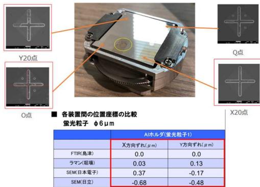
アライメントマーカを搭載した試料ホルダーと評価結果
